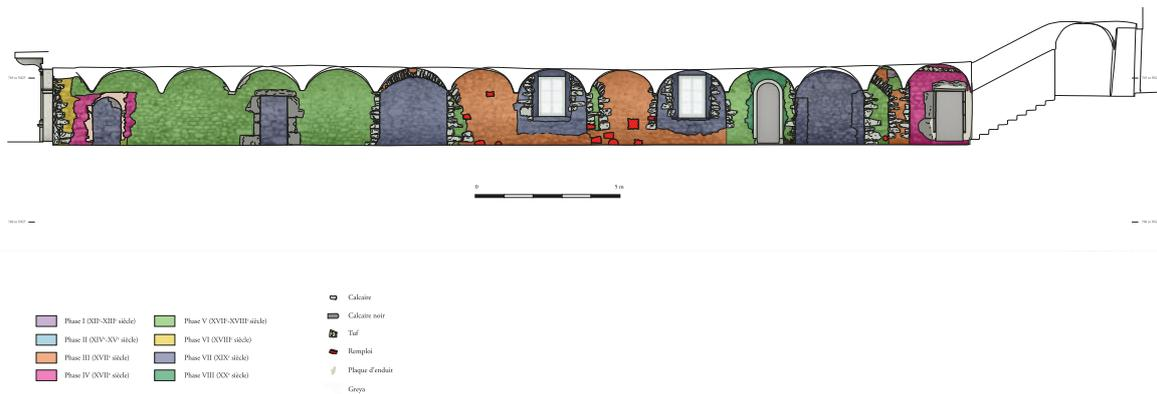
Fig. 12 – Élévation et phasage chronologique du mur nord du couloir du logis, parement sud.
