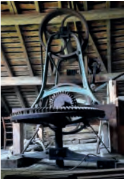
Vue des engrenages et des transmissions.
