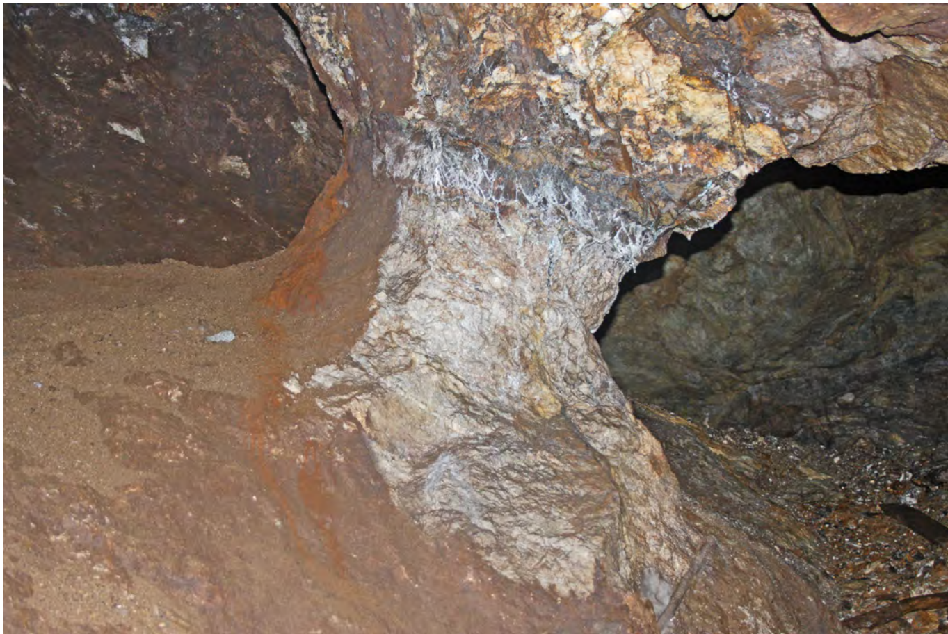
Pilier minéralisé de la mine des Hurltières.
