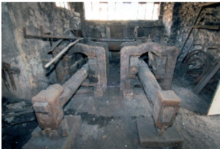
Les martinets, utilisés pour l'étrépage et le platinage. En position de travail, le forgeron était assis sur un siège à balancelle mobile accroché aux poutres du plafond.
