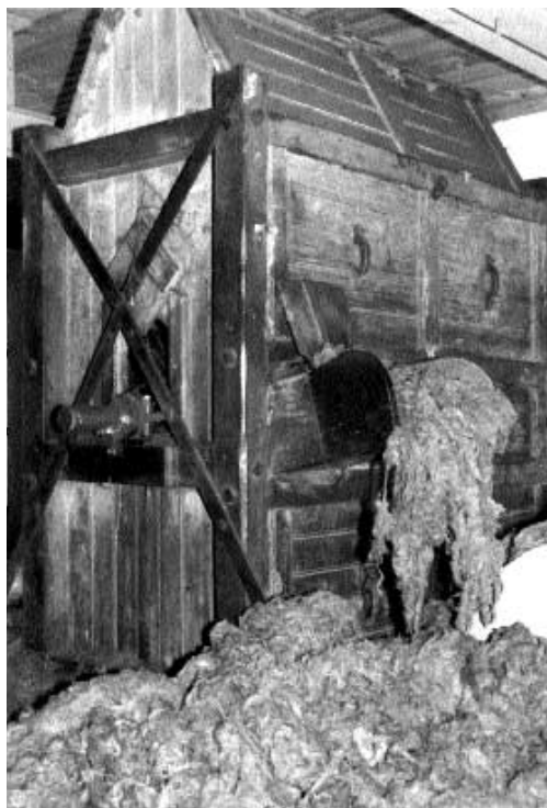
Batteur-mélangeur, servant à l'ouverture de la laine (1865).
