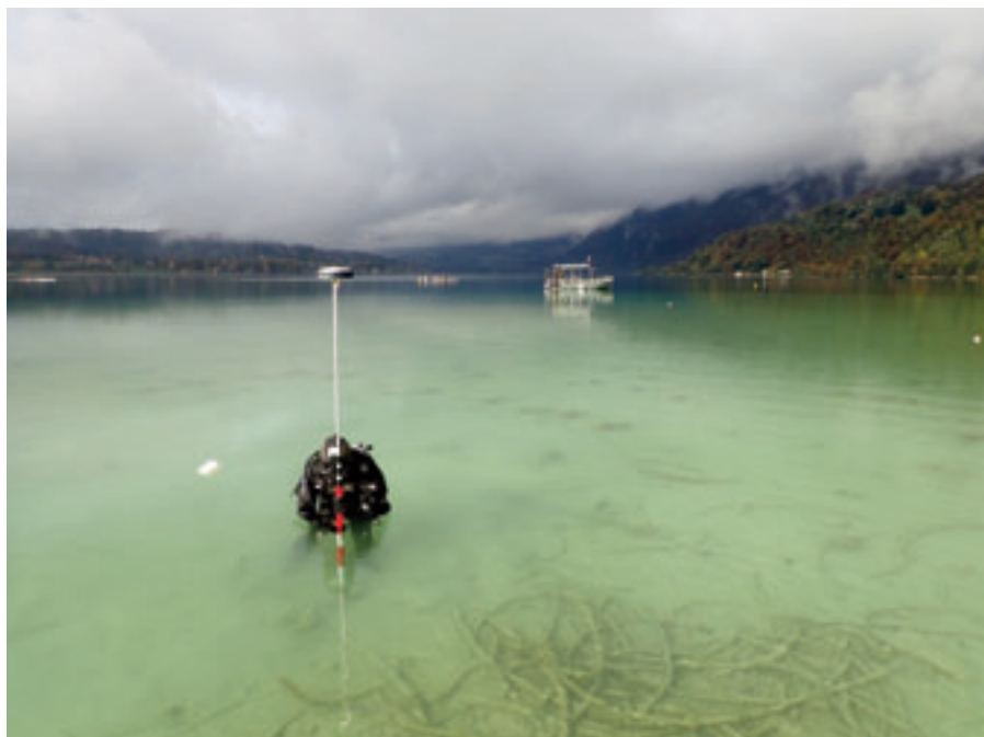
Relevé au GPS de précision sur la station néolithique de Beau Phare à Aiguebelette
