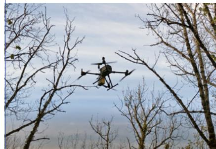
Drone d'AIRD'ECO-Drone avec le capteur LiDAR.
