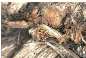
Fig. 4. Vue macroscopique des fibres de bois altérées par érosion et frottements. Gossissement x 20.
